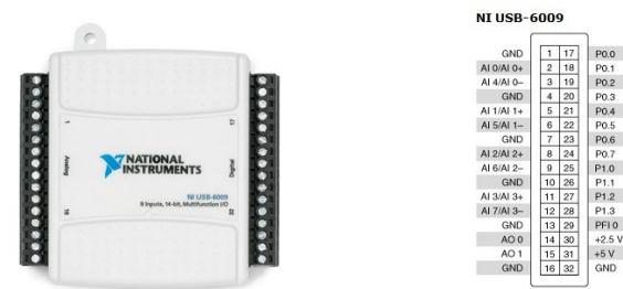
Slika 2: Kartica NI USB 6009 in razporeditev vhodno-izhodnih priključkov
