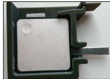
Slika 1. »Vroča točka« je načrtno povzročeno šibko mesto na keramiki, kjer tako načrtno formiramo zanesljivo mesto termičnega odklopa. Še posebej uporabno na DC sistemih (PV)!
