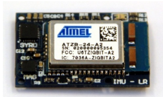
Slika 1: Inercijska merilna enota brez baterije. Njena velikost je 30x20x5 mm.
