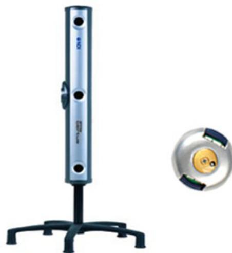
Slika 3: Sistem zajemanja gibanja z aktivnimi markerji OptoTrak.
