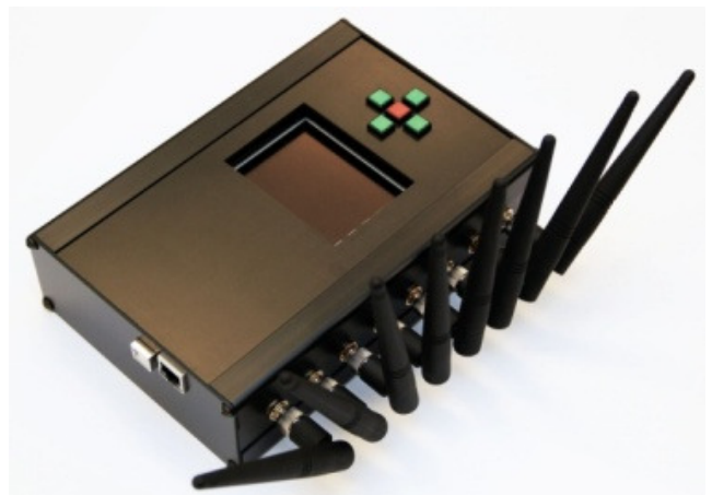
Slika 2: Osrednja enota z ločeno anteno za vsako IME. Njena velikost je 200x137x55 mm.
