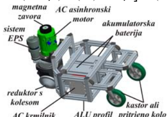
Slika 1: Mehanska konstrukcija mobilne platforme
