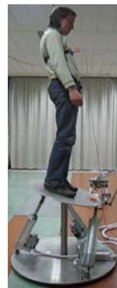
Slika 1: Premična ploščad (platforma): s katero pri našem postopku reguliramo težišče človeka.
