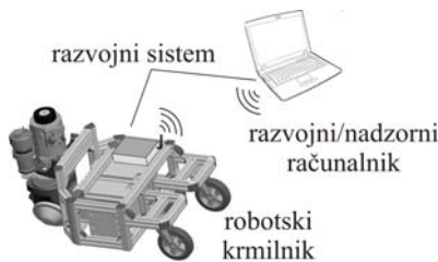
Slika 3: Konceptualni prikaz delovanja nadzorno/ciljnega sistema
